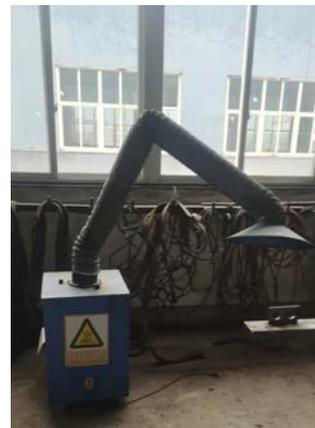
移动式焊接烟尘净化器
